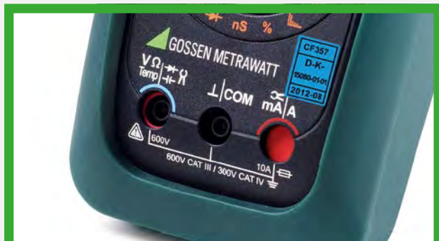
自动锁紧插座可防止错误连接测量电缆以及选择错误的测量档位
